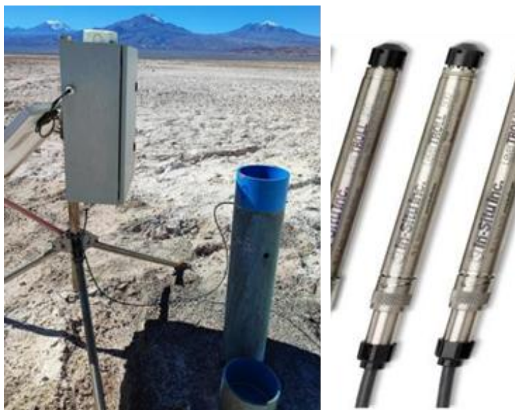
Figura 1: Izquierda: Pozo. Derecha: Sensor LevelTroll 500.
